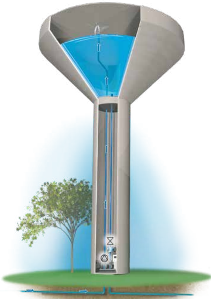
Château d'eau avec groupe de surpression et vanne de régulation
