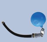
Flexible 2 m, crépine 1 mm, clapet anti retour, flotteur et raccord coudé 1" M. Elle est indispensable pour protéger la pompe et aspirer l'eau de la réserve sur son niveau le plus "propre" soit en partie supérieure.
