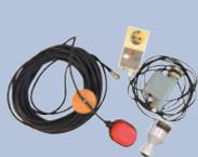
Coffret de commande avec flotteur de niveau, câble 20 m, vanne 2 voies et disconnecteur eau potable. Grâce à son flotteur placé dans la réserve à un niveau bas, le coffret commande la marche/arrêt de la pompe en cas de manque d'eau et l'ouverture/fermeture de la vanne. L'ajustement en eau potable se fait dans la réserve et seulement en cas de fonctionnement de la pompe. En cas de coupure électrique, la vanne magnétique est automatiquement fermée.
