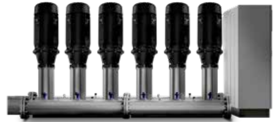
Figura 3: I sistemi multi-pompa compatti che integrano il controllo della velocità per aumentare o diminuire rapidamente la portata possono soddisfare una gamma più ampia di richieste con una maggiore efficienza energetica rispetto a quella offerta in genere dalle pompe ad aspirazione finale o a cassa divisa.
