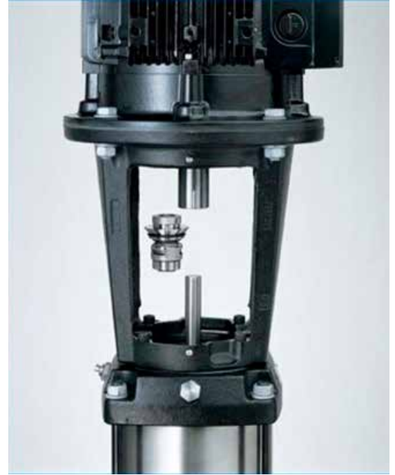
Figura 2: Una cartuccia di tenuta meccanica monoblocco facilmente accessibile può essere sostituita in pochi minuti, senza rimuovere il motore. Questo evita il tempo e lo sforzo tipicamente associati al riallineamento dei motori e dell'albero dopo la sostituzione della guarnizione sulle pompe ad aspirazione finale ad accoppiamento lungo e sulle pompe a cassa divisa.
